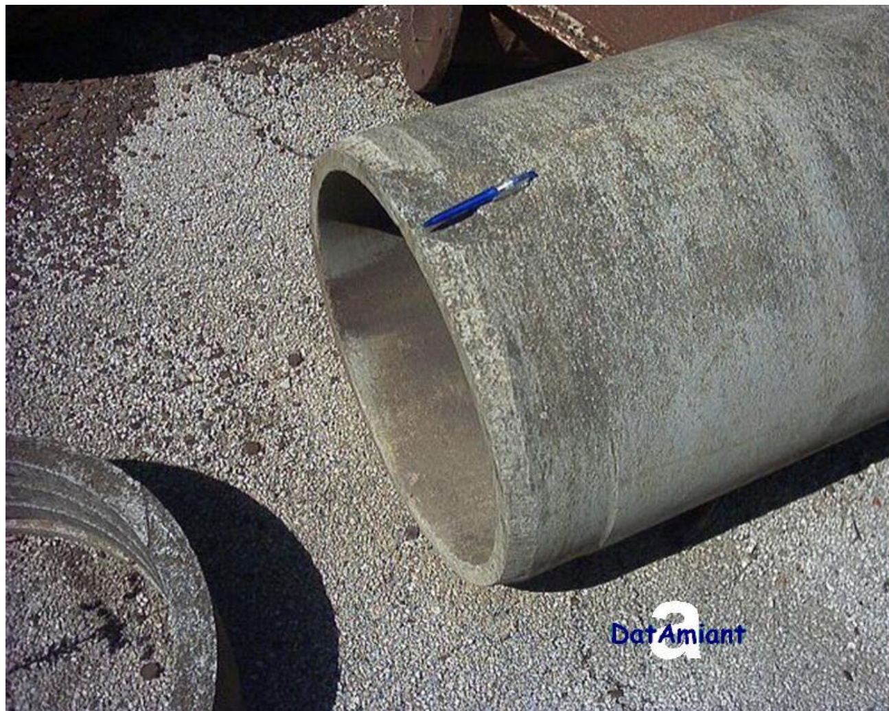
Area esterna di consorzio di bonifica Tubi per condotte idriche in cemento amianto (dettaglio)
