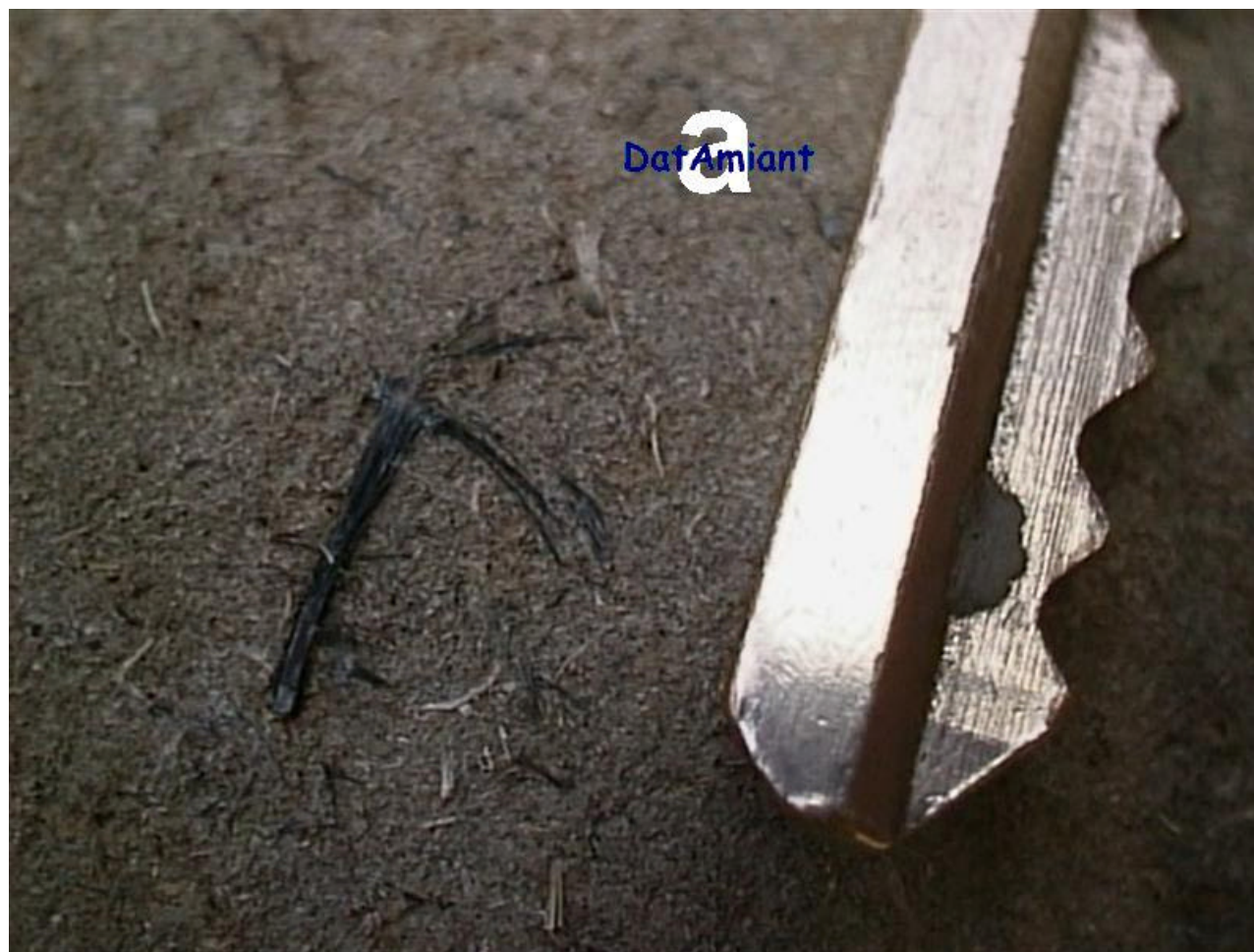
Terrazza di edificio con appartamenti Fibre di amianto affioranti dalla matrice cementizia di canna fumaria di caldaia (dettaglio)
