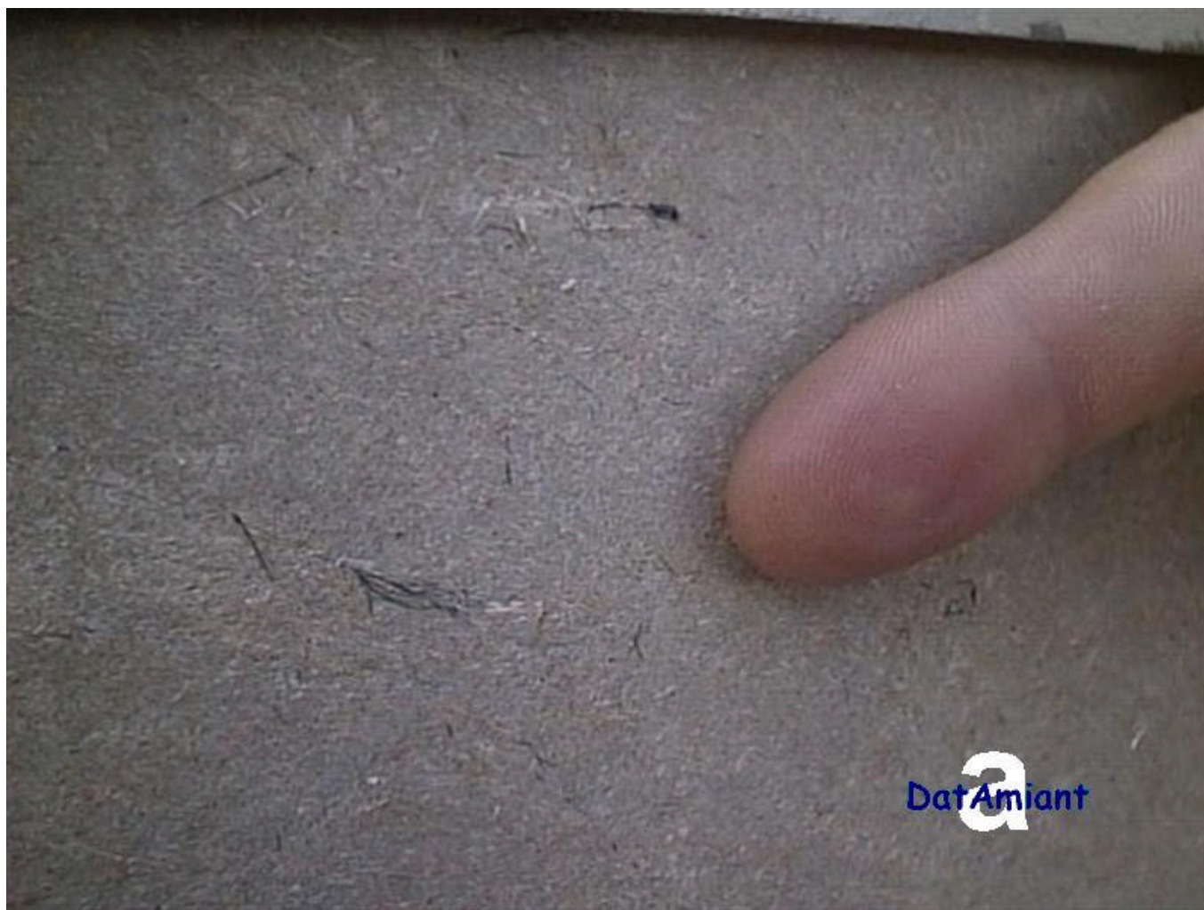
Terrazza di villetta Fibre di amianto in matrice cementizia di serbatoio idrico (dettaglio)
