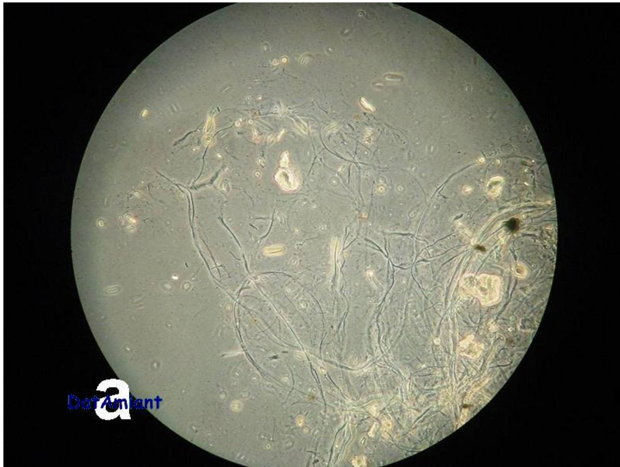
Osservazione di vetrino in microscopia ottica in contrasto di fase (MOCF) 500 X Fibre di crisotilo
