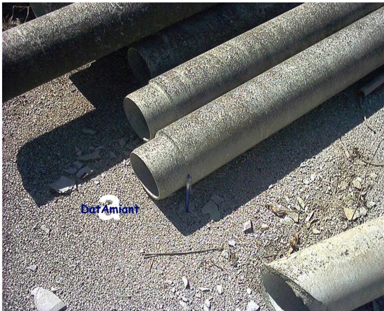
Area esterna di consorzio di bonifica Tubi per condotte idriche in cemento amianto (crisotilo e crocidolite)
