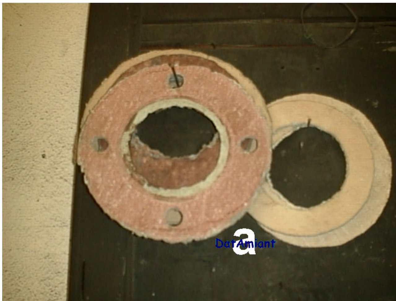
Locale caldaie di un ospedale Guarnizioni in cartone d'amianto sagomate manualmente
