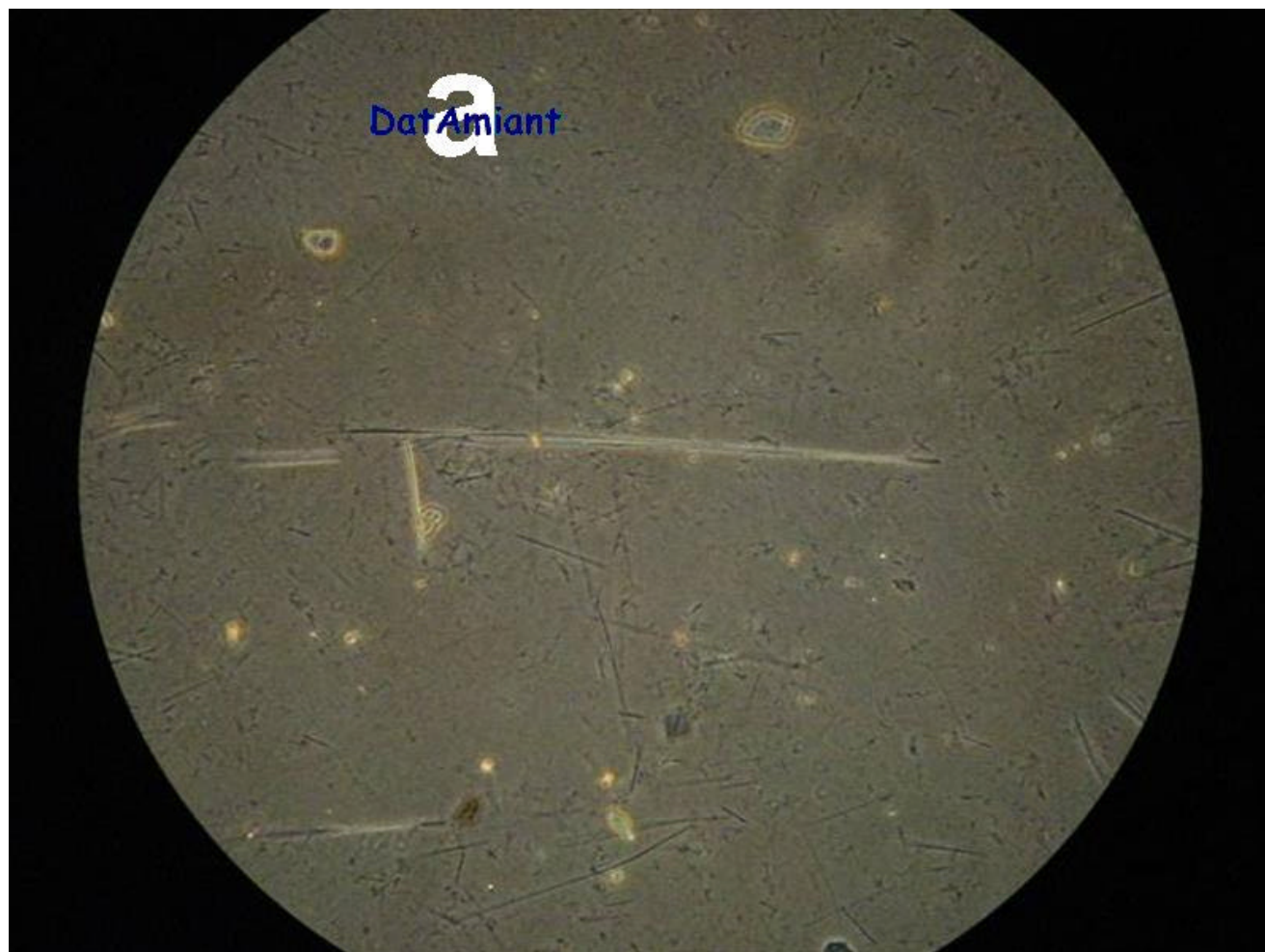
Osservazione di vetrino in microscopia ottica in contrasto di fase (MOCF) 500 X Fibre di crocidolite
