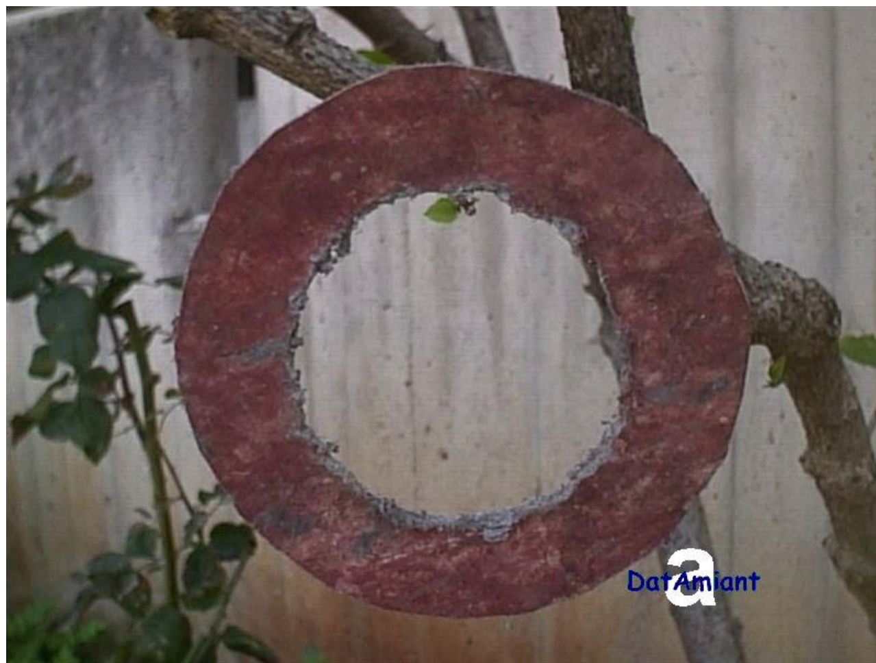
Guarnizione in cartone d'amianto sagomata manualmente
