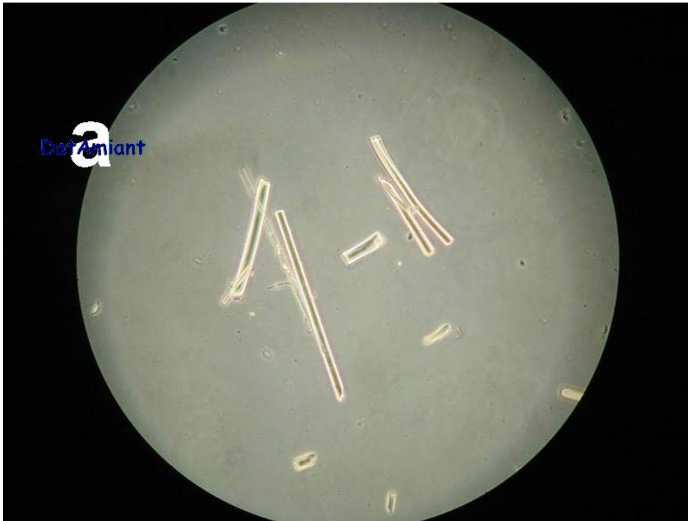
Osservazione di vetrino in microscopia ottica in contrasto di fase (MOCF) 500 X Fibre vetrose
