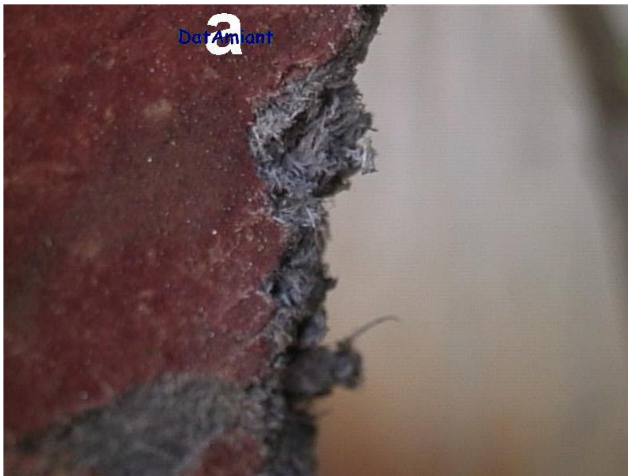
Guarnizione in cartone d'amianto sagomata manualmente (dettaglio)
