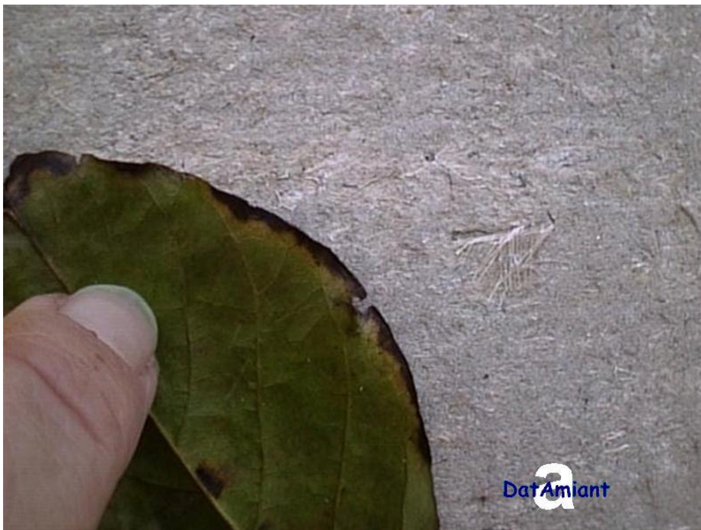
Terrazza di villetta Aggregato di fibre di amianto in matrice cementizia di serbatoio idrico (dettaglio)
