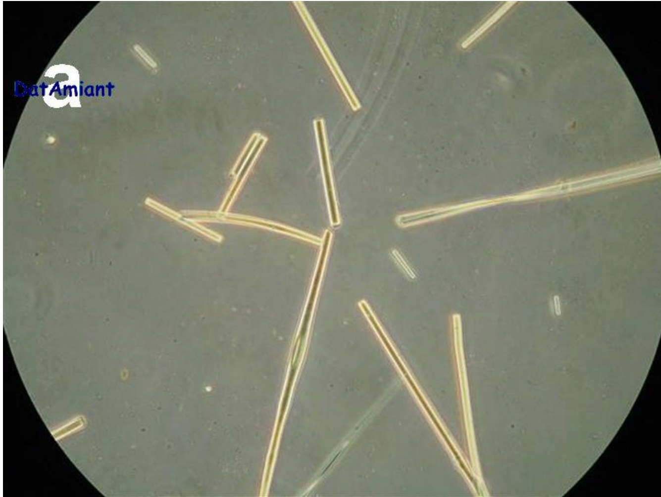
Osservazione di vetrino in microscopia ottica in contrasto di fase (MOCF) 500 X Fibre ceramiche
