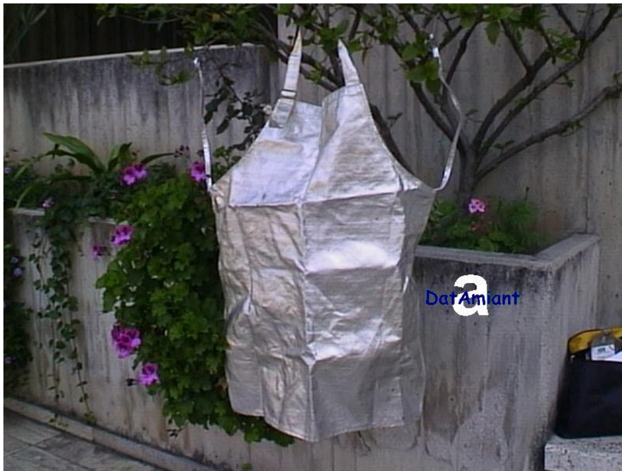
Grebiule in tessuto di crisotilo usato in passato nella cantieristica navale (parte esterna)
