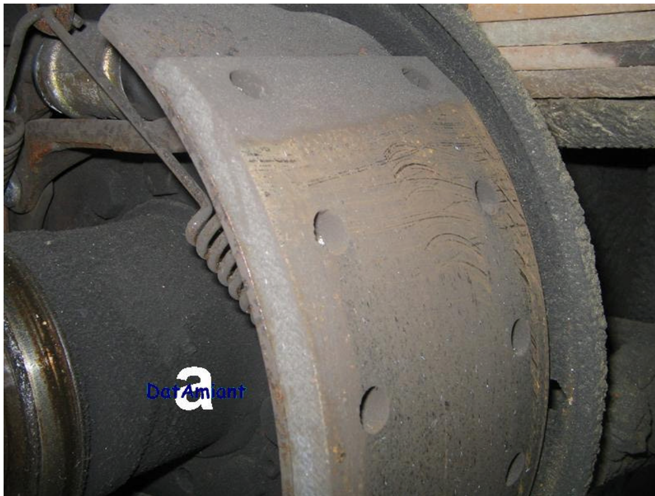
Officina meccanica Freno a tamburo di autocarro con guarnizione contenente amianto (dettaglio)
