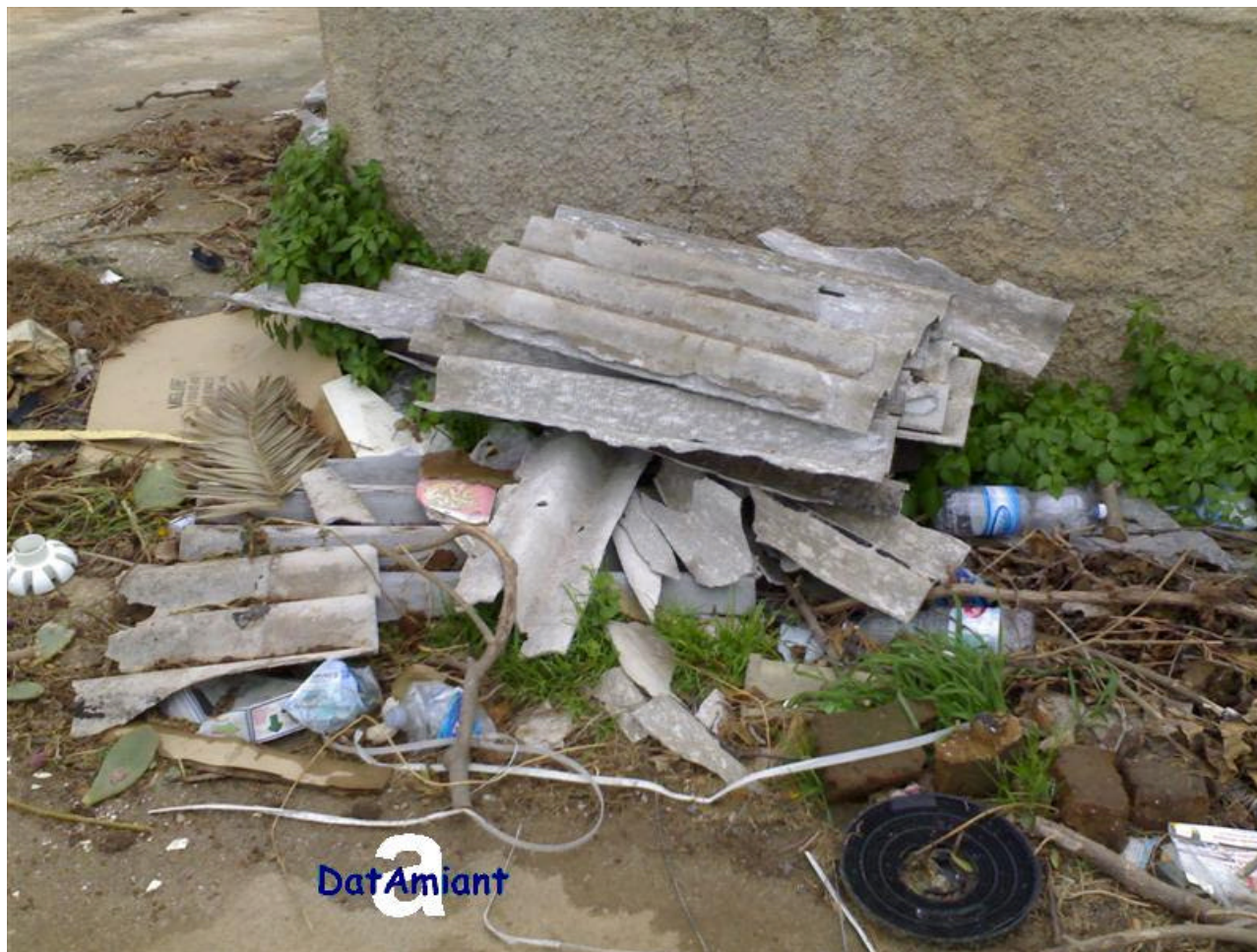
Discarica abusiva Pezzi di lastre in cemento amianto dismesse
