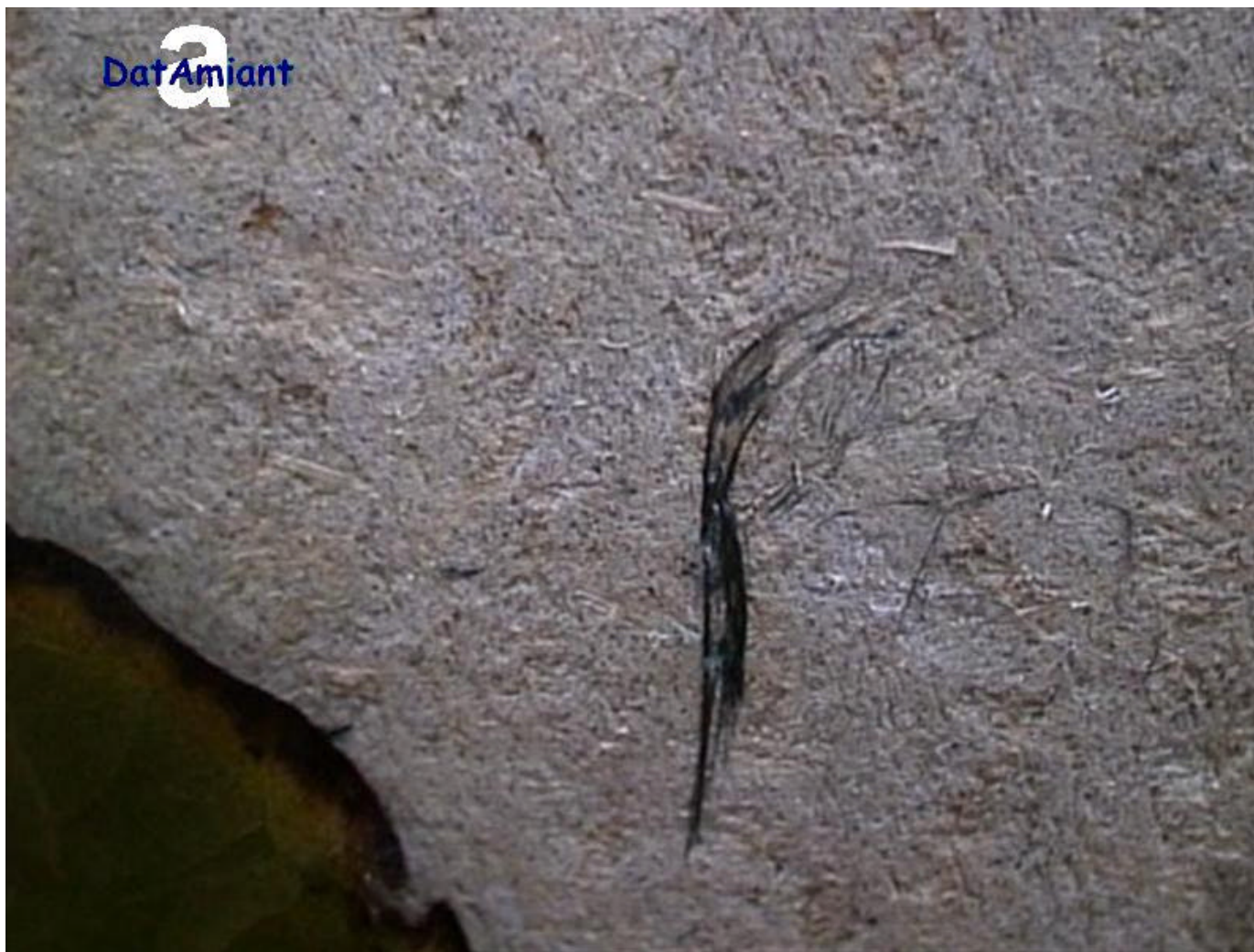
Terrazza di villetta Ciuffo di crocidolite affiorante nella matrice cementizia di serbatoio idrico (dettaglio)
