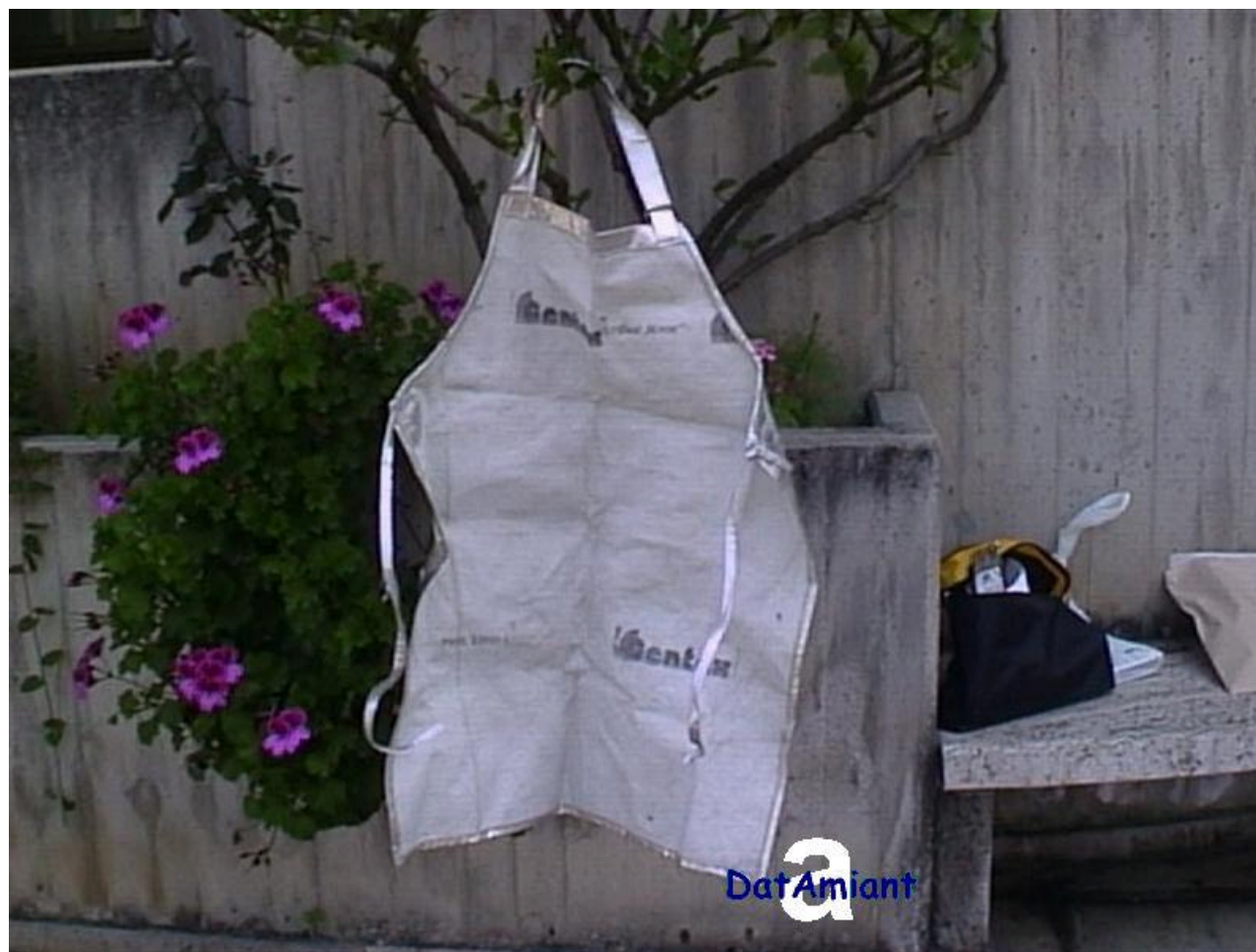
Grebiule in tessuto di crisotilo usato in passato nella cantieristica navale (parte interna)
