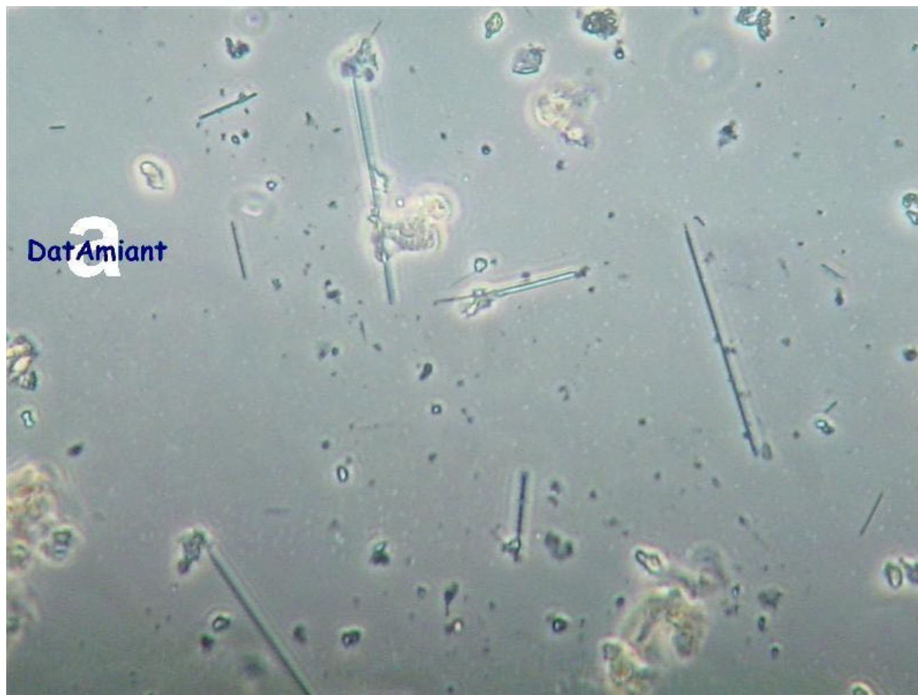
Osservazione di vetrino in microscopia ottica in contrasto di fase (MOCF) 500 X Campione in massa di coibentazione esterna di tubo vapore con fibre di amosite
