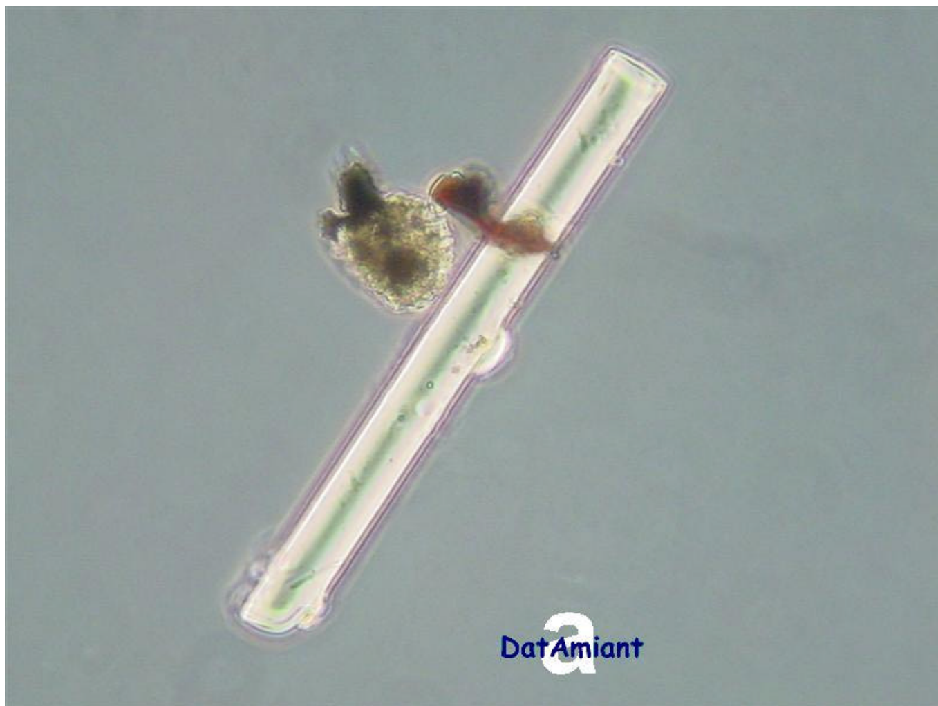
Osservazione di vetrino in microscopia ottica in contrasto di fase (MOCF) 500 X Campione in massa di coibentazione interna di tubo vapore con fibre vetrose (dettaglio)
