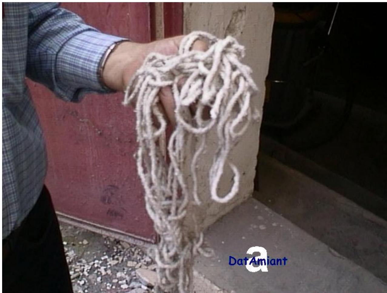
Locale caldaie di un ospedale Cordoncino in crisotilo per premistoppa
