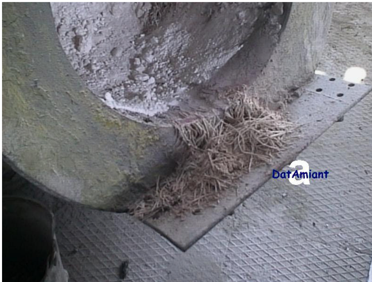
Azienda di prodotti a base di calce Residui di guarnizione in treccia di crisotilo nel portello di una camera di combustione in disuso (dettaglio)
