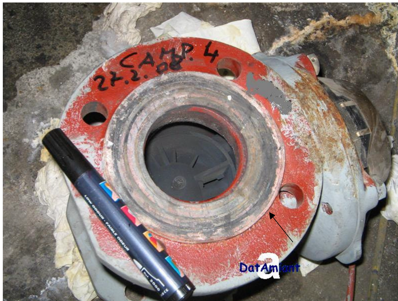
Centrale termica di edificio con uffici e appartamenti Flangia dismessa con guarnizione contenente crisotilo (dettaglio)
