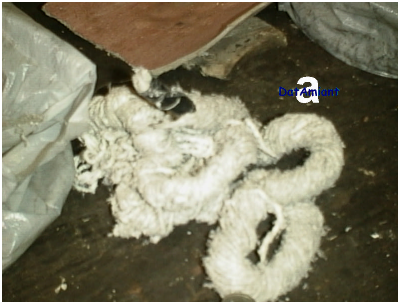
Locale caldaie di un ospedale Cordoncino in crisotilo per premistoppa su banchetto da lavoro
